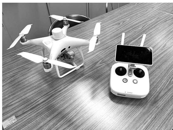
図2 測量用ドローン
